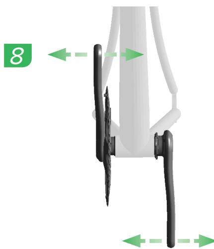
Pour pré-contraindre le pédalier, tournez la molette de réglage de la précontrainte vers le signe + jusqu'à ce qu'elle se bloque. Serrez le boulon de la molette de réglage de la précontrainte jusqu'à ce qu'il n'y ait plus d'espace. Vérifiez l'absence de jeu dans le pédalier en tirant les manivelles sur le côté.
